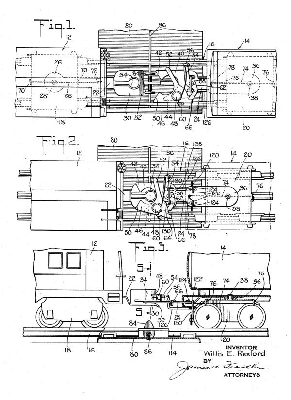
REMOTELY CONTROLLABLE AUTOMATIC TRAIN COUPLING SYSTEM
